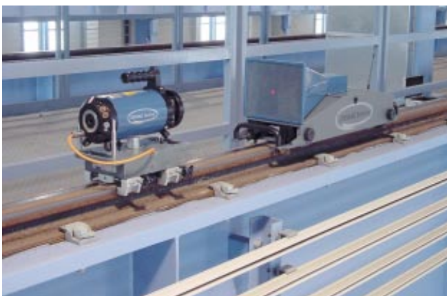
Demag-Lasermesssystem LMS im Einsatz
